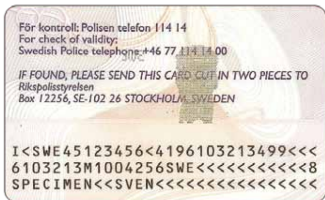
Figura 5-9: Zona de lectura mecánica de una tarjeta de identidad sueca de formato ID-1. (Cortesía de la policía sueca, Estocolmo, Suecia)
