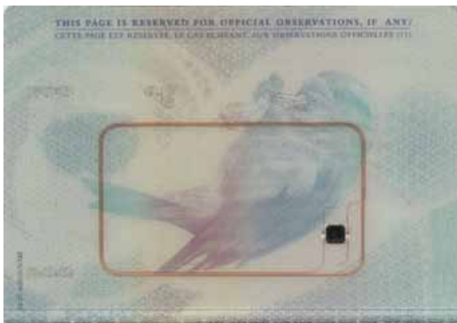
Figura 5-14: Microprocesador de proximidad de un pasaporte británico. (Cortesía del Servicio Nacional de Inteligencia Criminal, Países Bajos)
