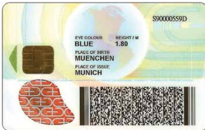
Figura 5-11: Código de barras bidimensional (2D) de una tarjeta. (Cortesía de Giesecke & Devrient , Munich, Alemania)
