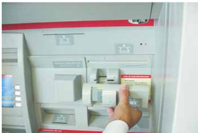
Figura 5-10: Dispositivo de duplicación colocado en la parte frontal de un cajero automático. El dispositivo de duplicación está copiando y almacenando la información de la banda magnética de una tarjeta de pago.
