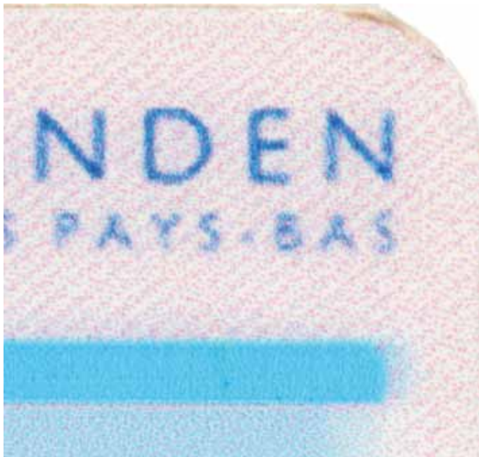
Figura 5-6: Tarjeta de identidad holandesa falsa impresa por chorro de tinta. Las características de los puntos de color se aprecian claramente (Cortesía de Sdu Identification , Haarlem, Países Bajos)
