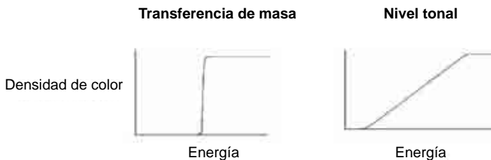
Figura 5-5: Impresión por transferencia térmica: diferencia entre la transferencia de masa y la transferencia de nivel tonal
